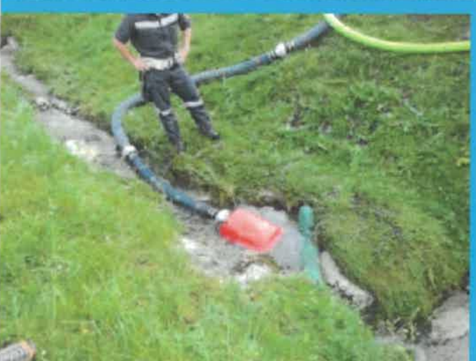
Geplo Saugkorb Storz A Schwimmsauger S50 Feuerwehr neues Modell 2016 Saugschwimmer
